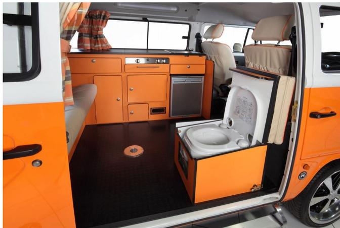
Figura 2 | Sanitário químico portátil instalado em *motorhome*.
