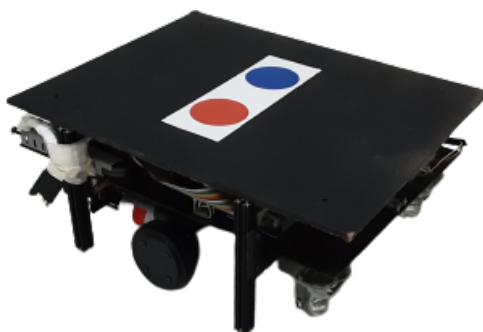
Figura 1 – Veículo autoguiado utilizado como base para o desenvolvimento e testes do módulo de software
