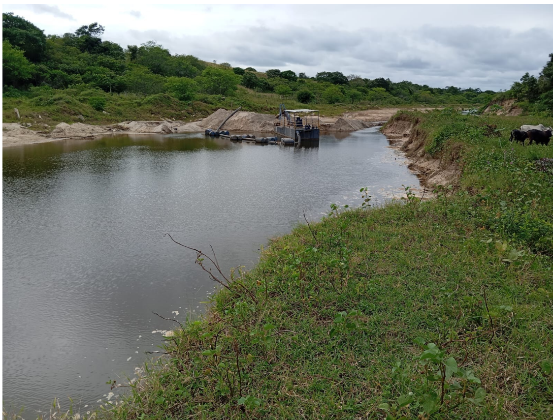
Figura 05 – Draga utilizada para extração de areia, instalada no baixo curso do Rio Potengi.
