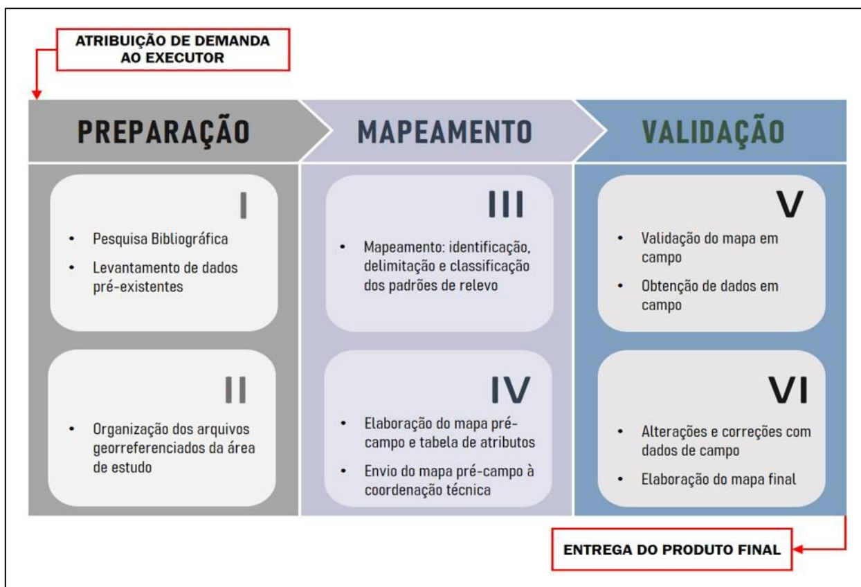
Figura 02 - Resumo gráfico das fases e etapas para elaboração de um mapa de padrões de relevo no âmbito do Departamento de Gestão Territorial (DEGET), SGB-CPRM.
