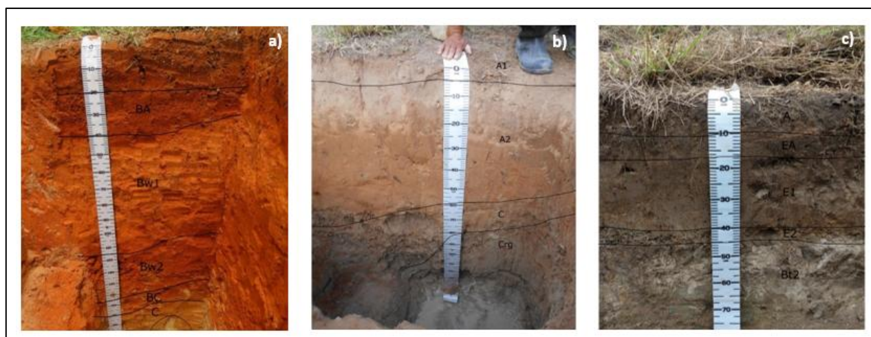
Figura 4 – Trincheiras de um Sistema Latossolo/Planossolo. a) Latossolo Vermelho-Amarelo Eutrófico Cambissólico; b) Neossolo Regolítico Psamítico Solódico Gleissólico; c) Planossolo Háplico Eutrófico Solódico. Fonte: Santos, 2025.
