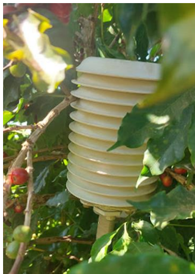
Figura 3 - Sensor instalado em abrigo meteorológico na copa do cafeeiro.
