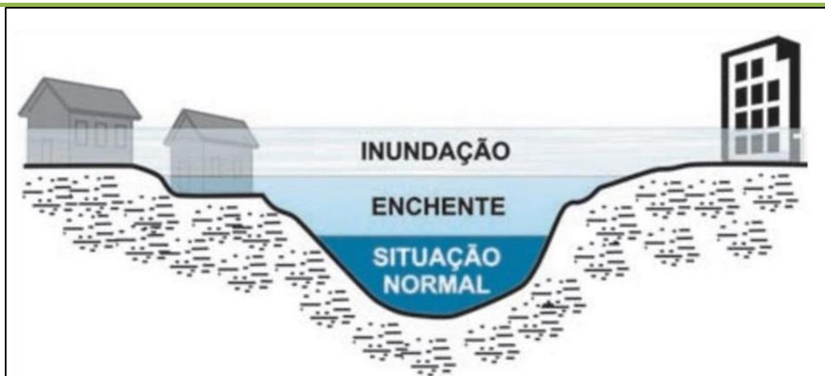
Figura 2 - Perfil esquemático do processo de enchente e inundação.
