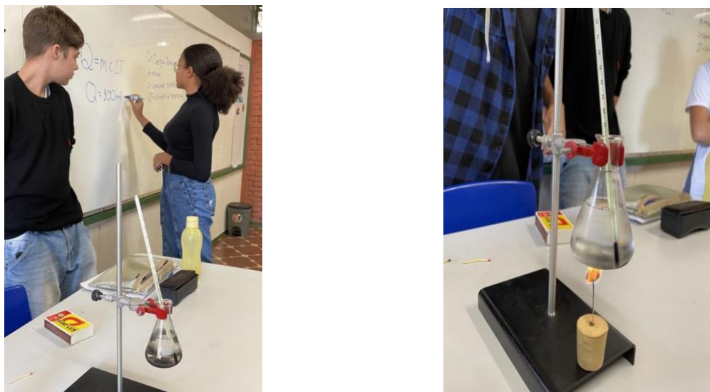
Figura 1: Experimento para estimar o valor calórico de um amendoim.
